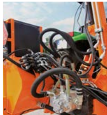
Zasilający układ hydrauliczny wraz z rozdzielaczem - wydajny i wytrzymały.
