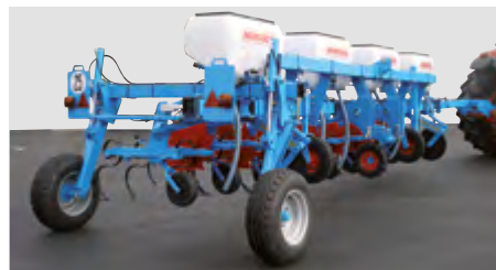
Pielnik sztywny 8-rzędowy TIP 5" z odległością między rzędami 70 cm podczas transportu
