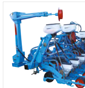
Składany hydrauliczny znacznik rzędów z tarczą do ramy składanej (dostępne różne modele w zależności od rodzaju ramy)
