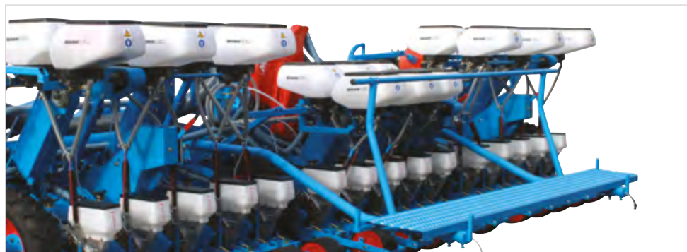
Przekładnia dystansowa nasion połączona z zestawem kół napędowych Minimalna odległość między rzędami (1): 43cm
