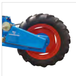
Przekładnia dystansowa nasion połączona z zestawem kół napędowych Minimalna odległość między rzędami (1): 43cm
